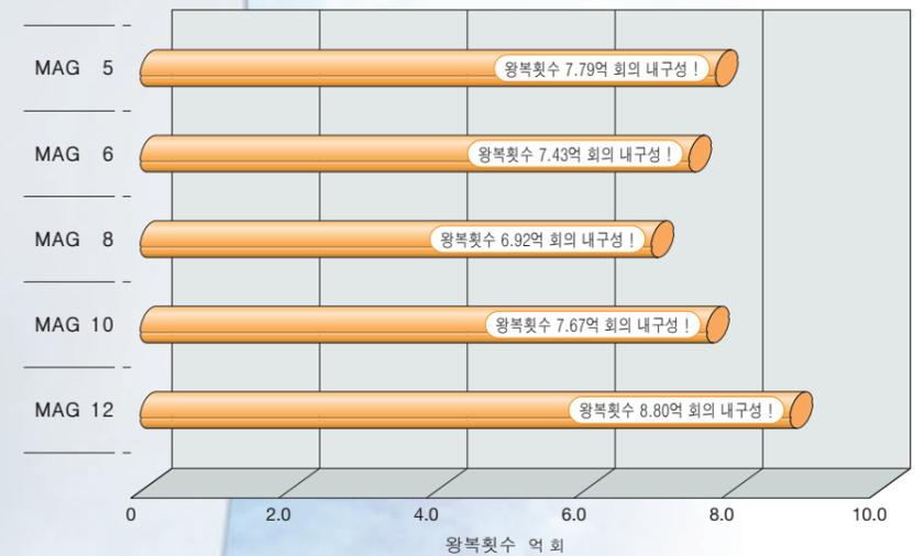
수직축 · 초고속 택타임 운전에서도 C루브 내의 윤활유만으로 총 2억 회를 문제 없이 왕복하는 뛰어난 내구성! 일반적인 칩 마운터에서의 사용을 가정한 시험 조건으로 10년에 상당하는 메인テナンス프리를 실현!!
